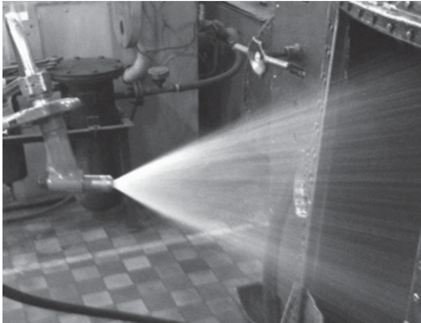
Рис. 3. Конус топливной струи на выходе из форсунки
