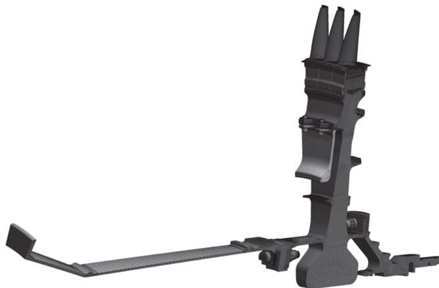
Рис. 4. Конечноэлементная модель ротора ТВД
