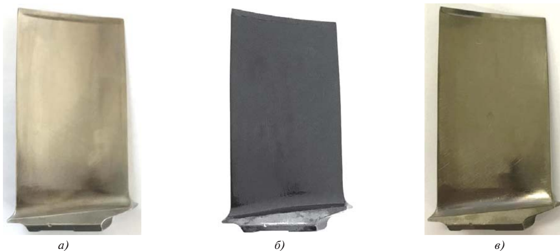
Рис. 3. Вид лопатки № 2: а — в исходном состоянии; б — после нанесения загрязнений; в — после удаления загрязнений
