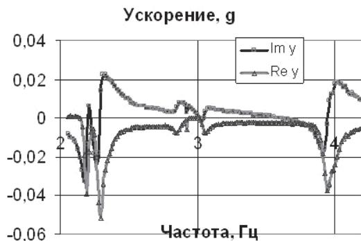
Рис. 7. Частотные характеристики ускорений двигателя при моделировании вращающейся силы
