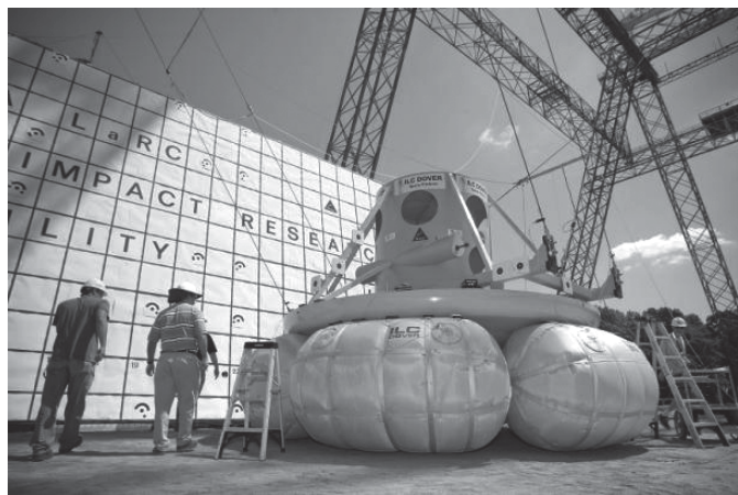
Рис. 2. Системы энергопоглощения космического корабля ORION
