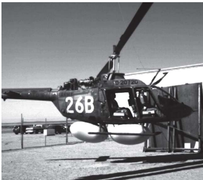
Рис. 1. Система энергопоглощения на вертолете Bell 206
