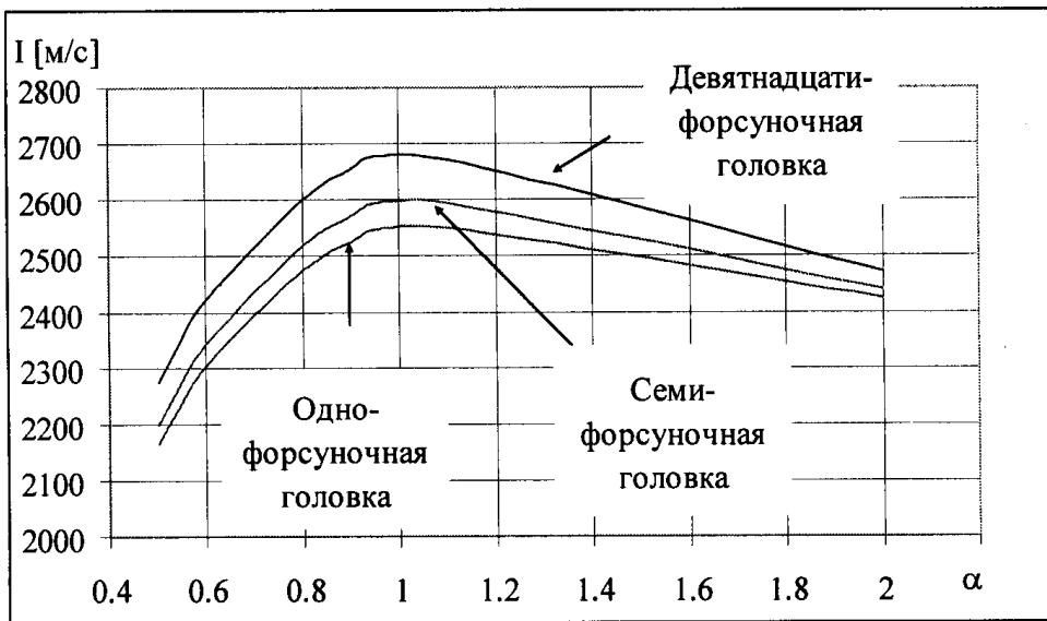
Рис. 8. Расчетная зависимость удельного импульса двигателя от коэффициента избытка окислителя для различного числа форсунок в смесительной головке
