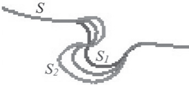
Рис. 2. Принцип разложения движения. Траектория движения основных осей S_1 , дополнительных — S_2 , результирующее движение — траектория S
