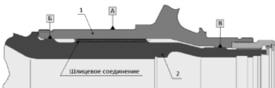
Рис. 1. Шлицевое соединение цапфы и вала: 1 — цапфа ТНД; 2 — вал ТНД
