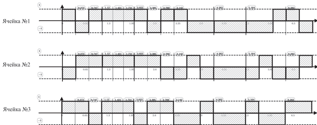
Рис. 9. Предлагаемый алгоритм включения отдельных ячеек
