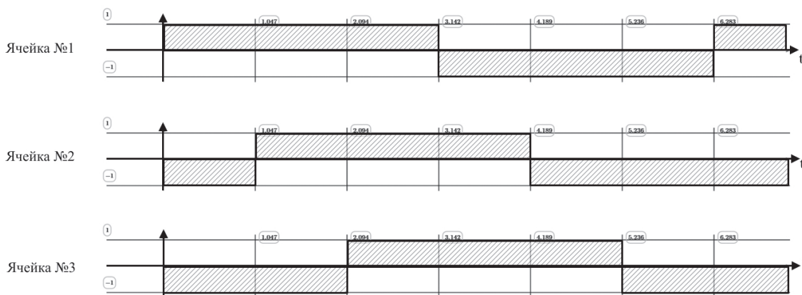
Рис. 3. Алгоритм включения отдельных ячеек при равномерном сдвиге
