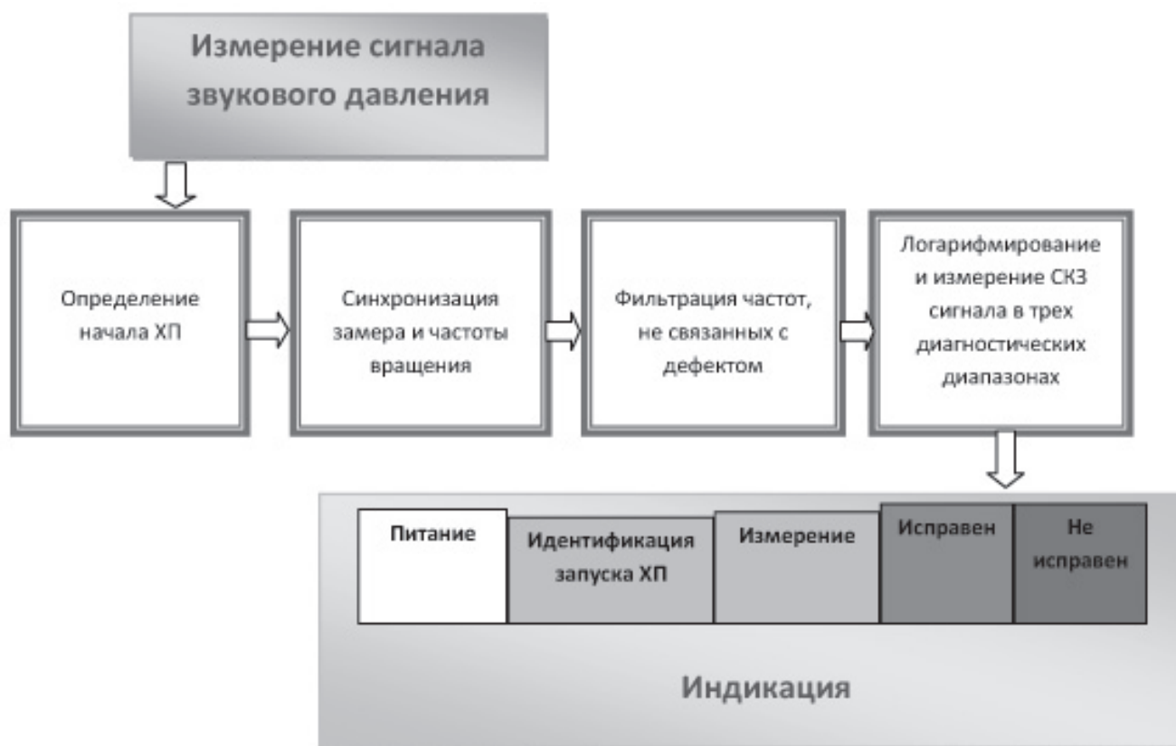
Рис. 7. Структурная схема ЭБАИ «Фианит 3000»
