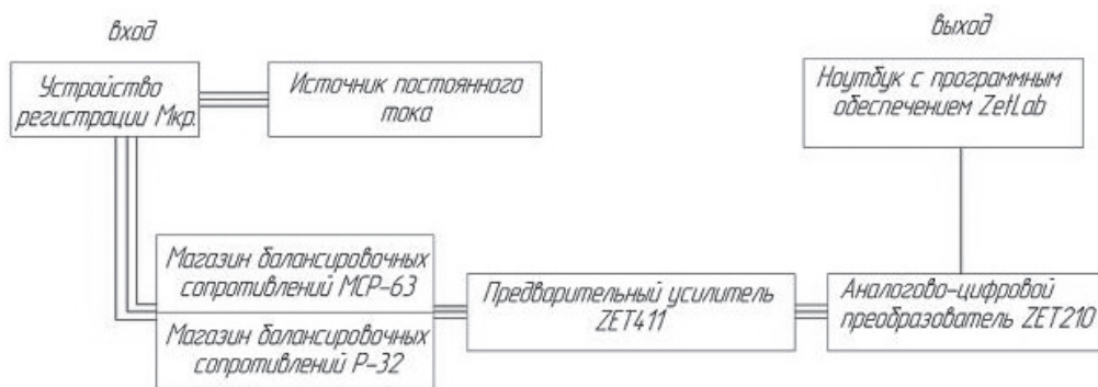
Рис. 6. Блок-схема устройства регистрации и записи крутящего момента
