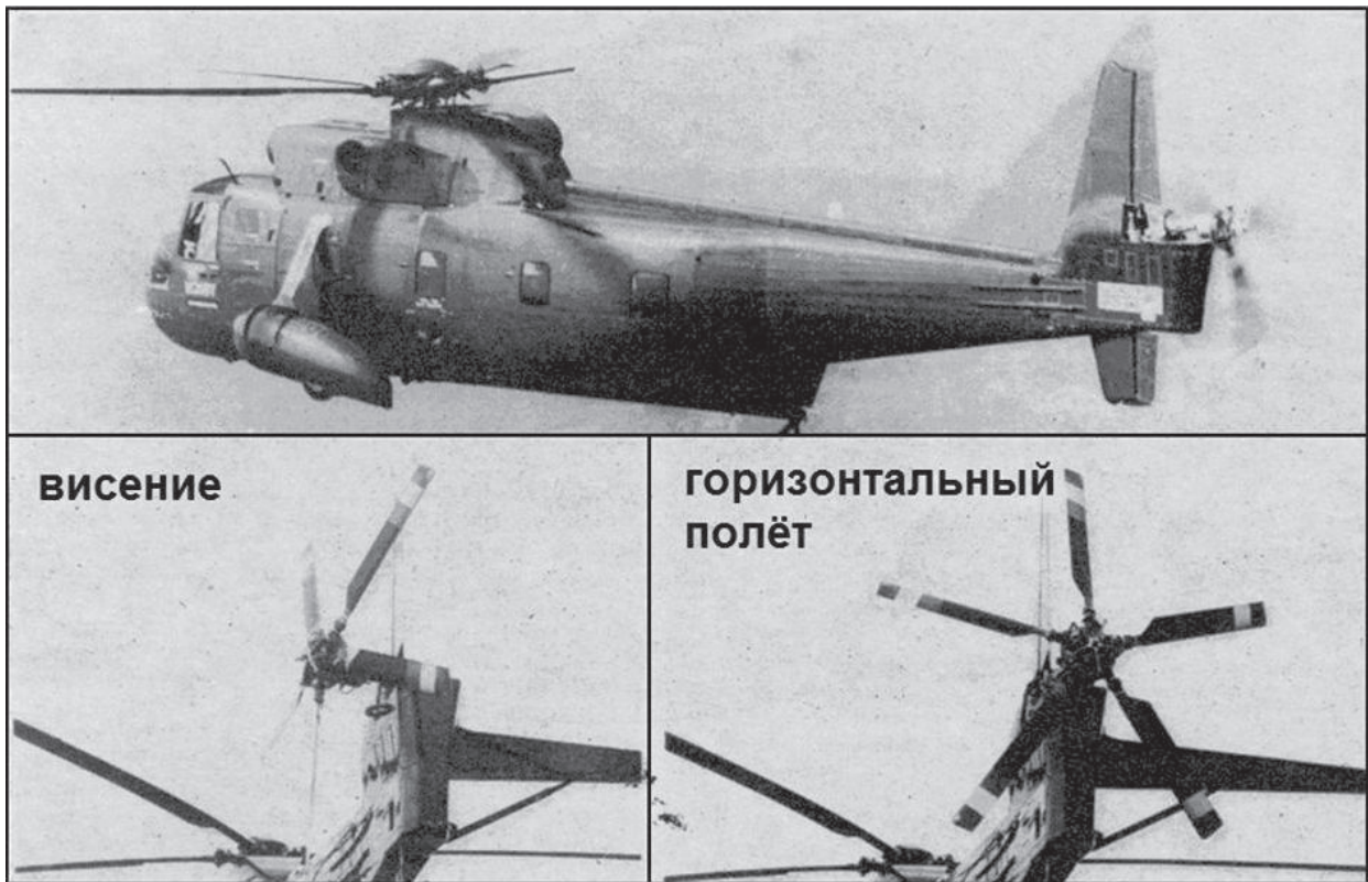
Рис. 3. Поворотный рулевой винт на вертолёте Sikorsky S-61
