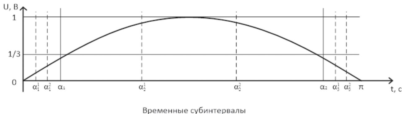
Рис. 3. Разбиение уровней напряжения по времени включения каждой ячейки исходя из числа ячеек
