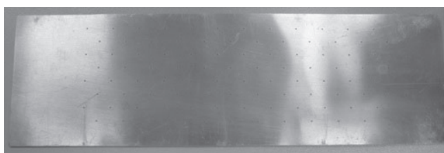
Рис. 12. Общий вид образца с упорядоченной пористой структурой, полученной методом механического сверления
