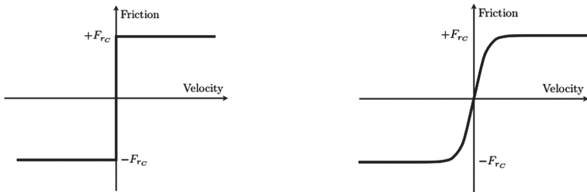
Рис. 10. Модель кулонова сухого трения с использованием функций \text{sign}(X) (слева) и \text{tanh}(X) (справа)
