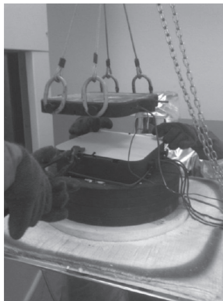
Рис. 9. Оснастка для формовки многослойных панелей
