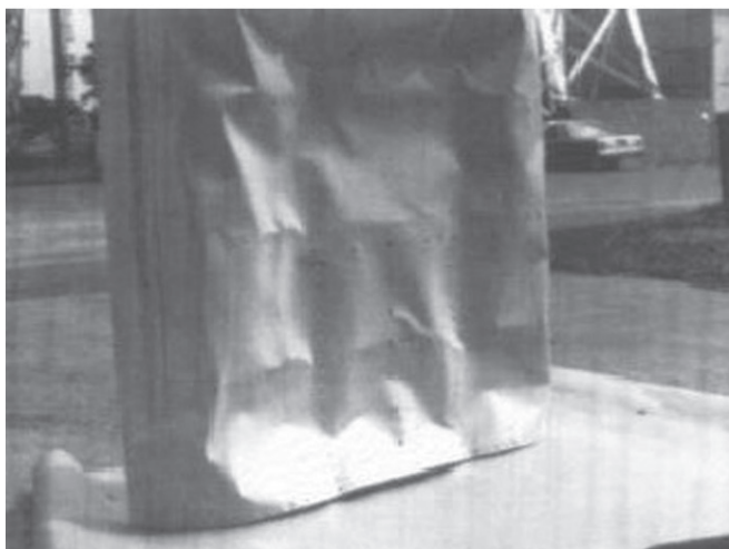
Рис. 6. Результаты эксперимента и конечно-элементного расчета при сбросе нижней панели на водную поверхность
