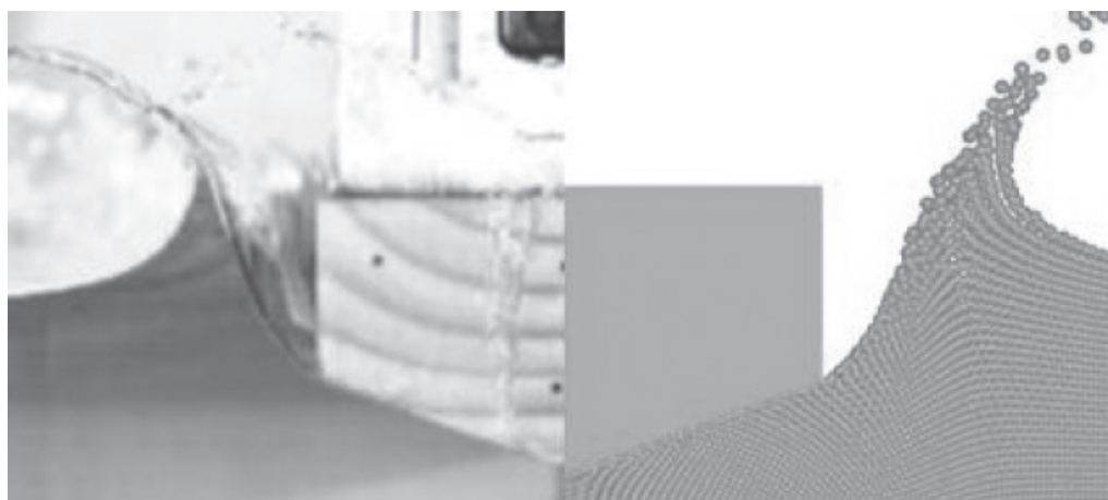
Рис. 5. Процесс погружения в воду клина (слева — эксперимент, справа — математическое моделирование)
