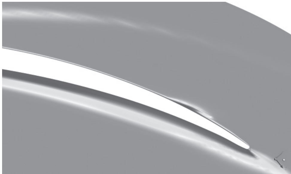
Рис. 8. Распределение перемежаемости, модель SST \gamma-Re_\theta , задняя кромка лопатки рабочего колеса 0.5h, минимальное число Re
