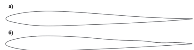
Рис. 1. Сравнение двух профилей с использованием ограничения по локальной кривизне (а) и без ограничения (б)
